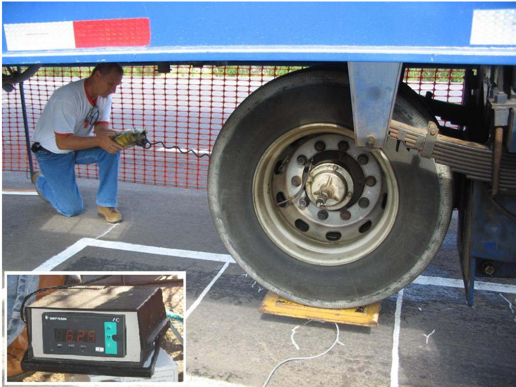
Figura 38: Calibração da carga a ser aplicada pelo rodado com o uso de uma célula de carga (em detalhe a leitura da célula de carga).
