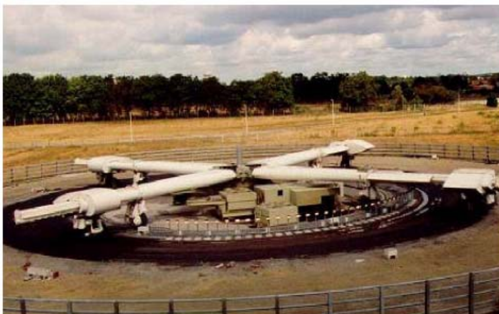
Figura 3: Simulador de tráfego circular do LCPC na França (Corté, 2001, apud Rohde, 2007).
