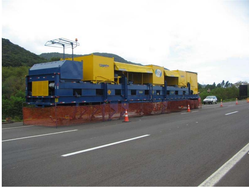
Figura 22: Simulador de tráfego tipo HVS empregado na pesquisa.
