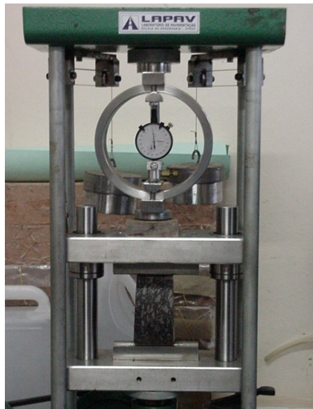
Figura 50: Equipamento utilizado para determinação de resistência a tração por compressão diametral das amostras deste estudo.
