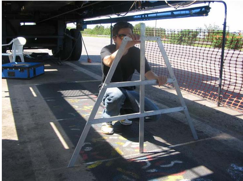
Figura 44: Exemplo de medida do afundamento de trilha de roda sendo realizada neste experimento.
