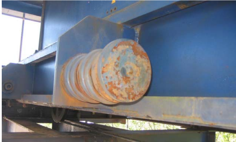
Figura 28: Detalhe do elemento de amortecimento do simulador de tráfego.
