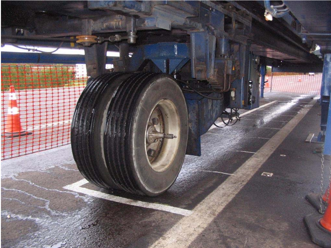
Figura 32: Detalhe do sistema de rodado do simulador de tráfego.
