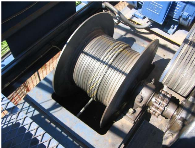
Figura 29: Detalhe do sistema de acionamento do simulador de tráfego.
