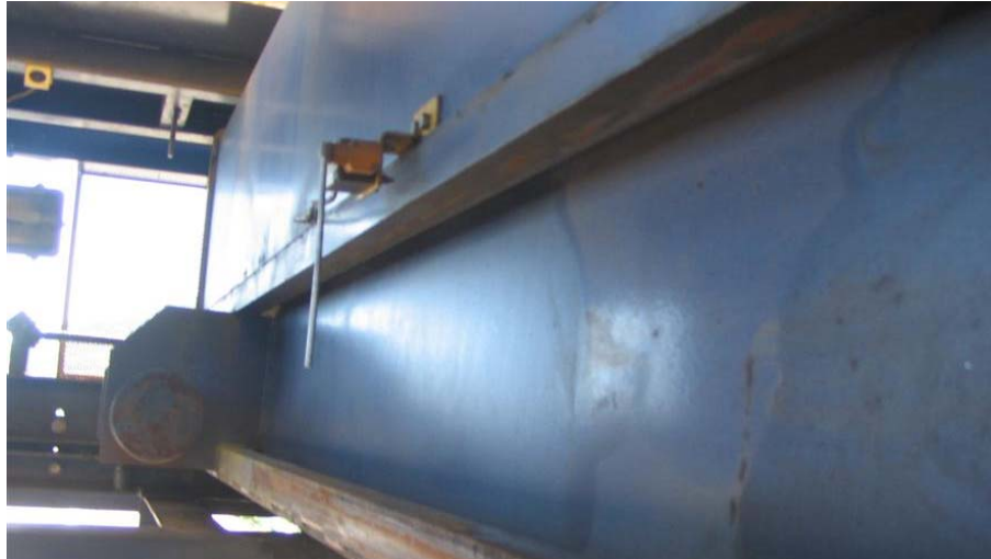
Figura 30: Detalhe dos sensores indutivos do simulador de tráfego.
