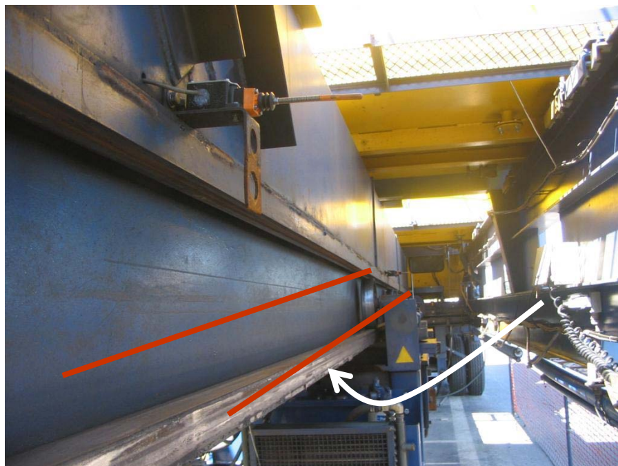
Figura 23: Detalhe do guiamento do simulador de tráfego.
