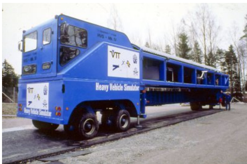
Figura 9: Simulador de tráfego móvel, modelo HVS (Heavy Vehicle Simulator), desenvolvido em uma cooperação entre a Suécia e a Finlândia (E-CORE, 2008).
