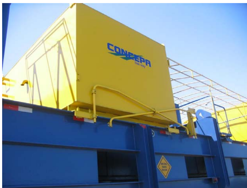
Figura 34: Detalhe de um dos tanques de água do simulador de tráfego.
