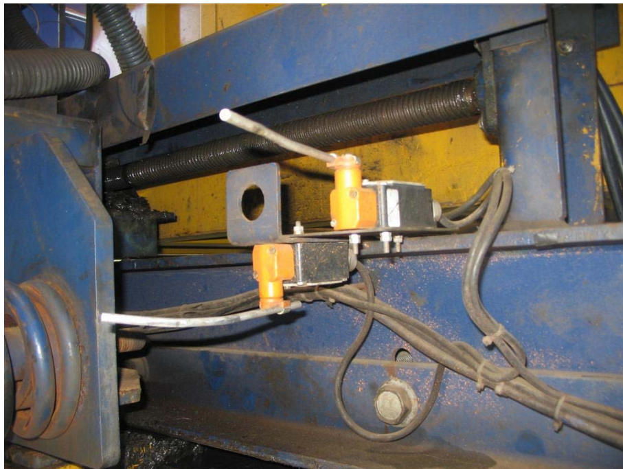
Figura 27: Detalhe dos sensores que controlam o deslocamento transversal do simulador de tráfego.
