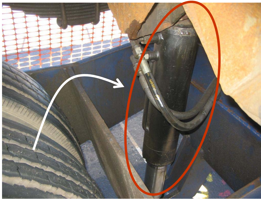
Figura 24: Detalhe da unidade hidráulica do simulador de tráfego.
