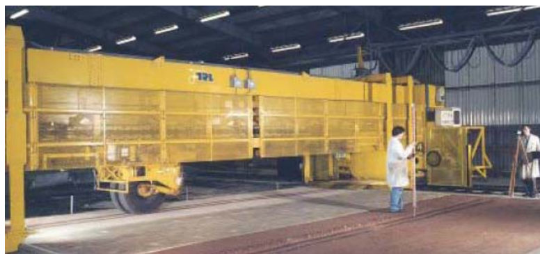
Figura 7: Simulador de tráfego linear do TRL (TRB, 2006, apud Rohde, 2007).
