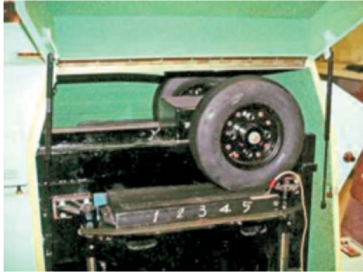
Figura 1: Simulador de tráfego de laboratório tipo LCPC da USP/SP (Bernucci et al. , 2006).
