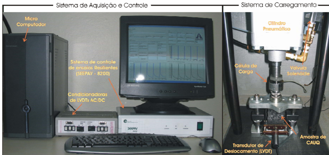
Figura 52: Equipamento do Laboratório de Pavimentação da UFRGS utilizado para determinação do módulo de resiliência (Brito, 2006).
