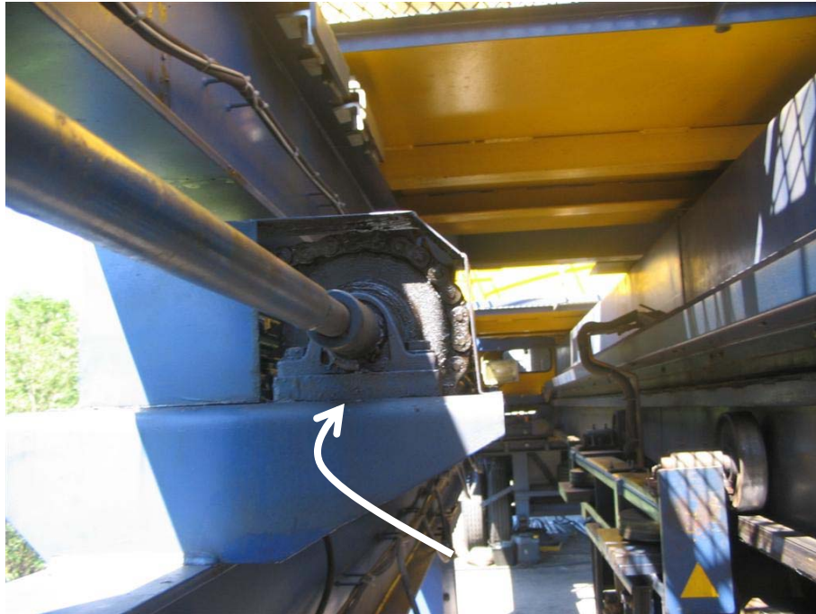
Figura 26: Detalhe do elemento mecânico responsável pelo deslocamento transversal do simulador de tráfego.
