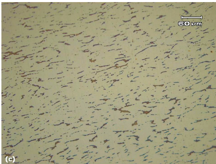
Figura 5.3 Microestrutura do AIS na condição temperado. (a) e (b) Martensita não revenida apresentando baixa quantidade de precipitados e ilhas de ferrita- \delta (fase escura). Aumento: (a)500x e (b)1000x. Ataque: Vilella. (c) Distribuição da ferrita- \delta na microestrutura (fase escura). Aumento: 200x. Ataque: Eletrolítico em solução de KOH.
