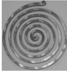
(a) Bobina espiral. Foto do trabalho de Paese et al. (2011).
