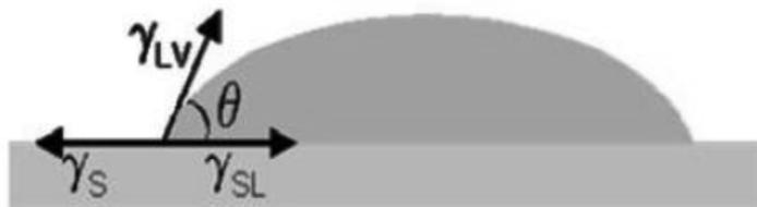
Figura 3 - Definição do ângulo de contato (Adaptado de [25])
