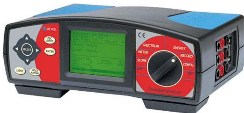
Figura 18: Analisador de qualidade de energia usado.
