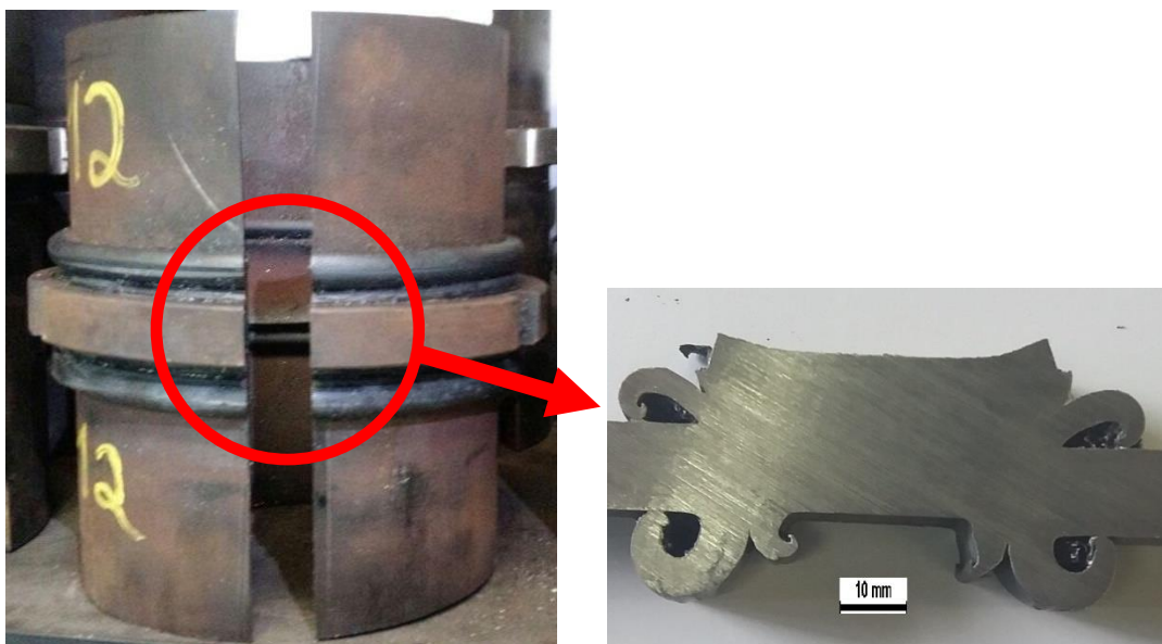
Figura 7: Figura mostrando o local onde foi retirado um dos corpos de provas (à esquerda) e a amostra submetida a análise (à direita).
