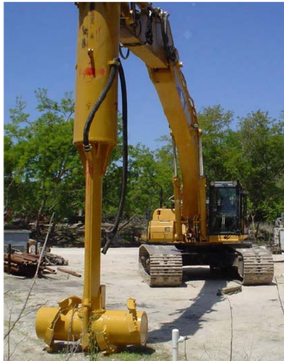
Figura 2 – Tipo de equipamento para estabilização em massa, com ferramenta de mistura com eixo de rotação horizontal e lâminas de mistura verticais.
