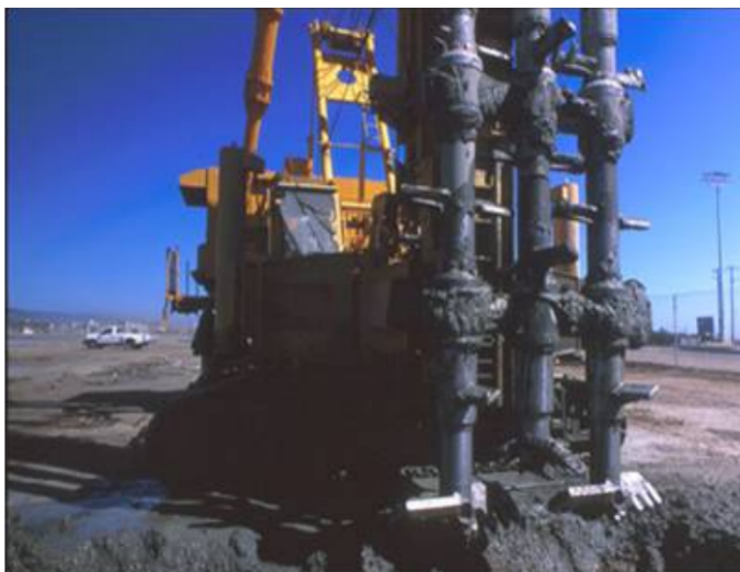
Figura 8 – Equipamento de mistura profunda; pode ser tanto utilizado para colunas (de até 40 m), quanto para estabilização em massa (para profundidades mais rasas).
