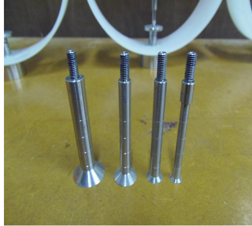
Figura 3 – Barras de base plana (penetrômetros de base plana) com diferentes áreas da ponta (4,0 cm 2 , 2,0 cm 2 , 1,0 cm 2 e 0,5 cm 2 ).
