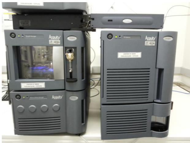
Figura 6: Cromatógrafo UPLC-MS/MS (Ultra Performance Liquid Chromatography acoplado à espectrometria de massas sequencial), Porto Alegre, 2016.
