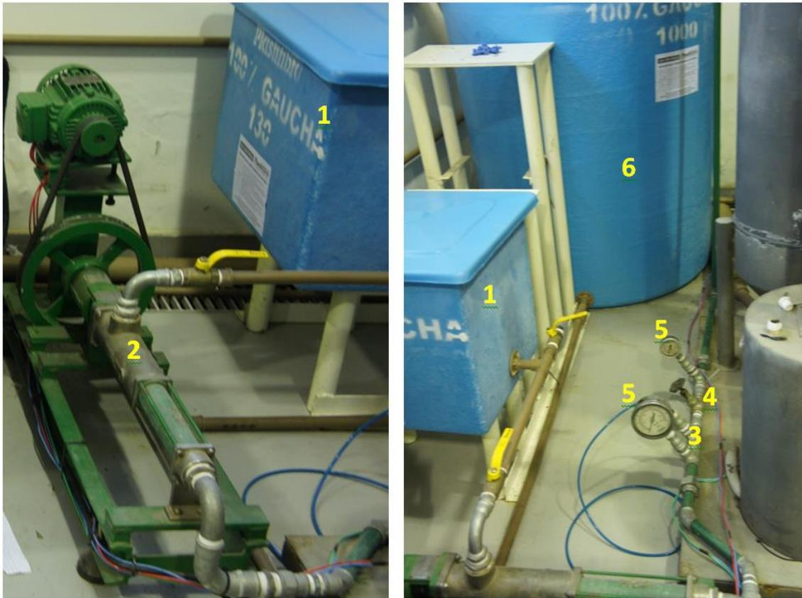
Figura 23. Unidade de preparo de emulsão oleosa. 1. Tanque pulmão para alimentação de água; 2. Bomba helicoidal; 3. Ponto de injeção de petróleo; 4. Válvula agulha (constritor de fluxo); 5. Medidores de pressão ( $\Delta P$ ); 6. Tanque pulmão de armazenamento de emulsão
