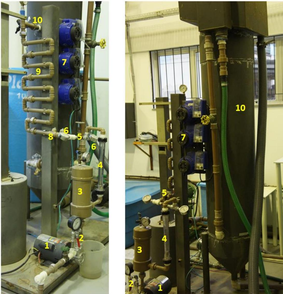
Figura 24. Unidade de floculação-flotação de água produzida simulada. 1. Bomba centrífuga multifásica para geração de bolhas; 2. Fluxômetro de injeção de ar; 3. Tanque alívio de excesso de ar; 4. Medidor de vazão; 5. Válvula agulha; 6. Medidores de pressão; 7. Bombas dosadoras de reagentes de floculação; 8. Ponto de injeção de reagentes de floculação; 9. Floculador hidráulico; 10. Coluna de flotação.
