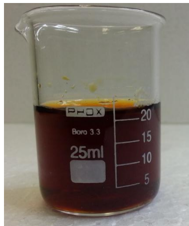
Figura 13. Coagulante Produzido a partir de Sulfato Ferroso.
