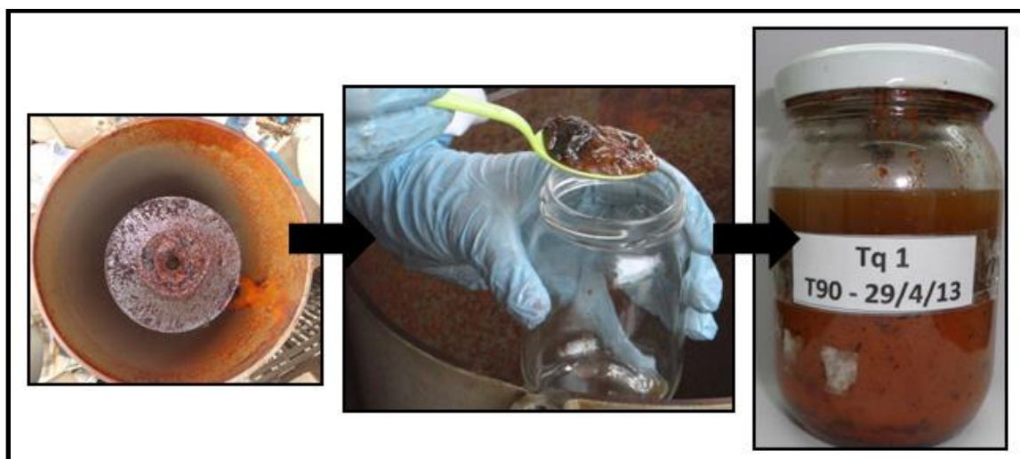
Figura 6. Aparência interna do tanque e aspecto do material coletado (origem química ou biológica) encontrado no fundo dos tanques com adição de água (Tanques 1, 2, 5, 6), após 90 dias de experimento.
