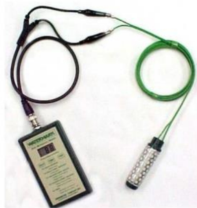
Figura 6. Sensor Irrometer Watermark 200SS utilizado para as medições de tensão.
