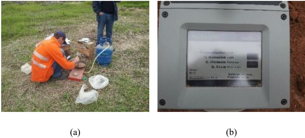
Figura 3.17 Controle da umidade. (a) Método de campo. (b) Densímetro não nuclear
