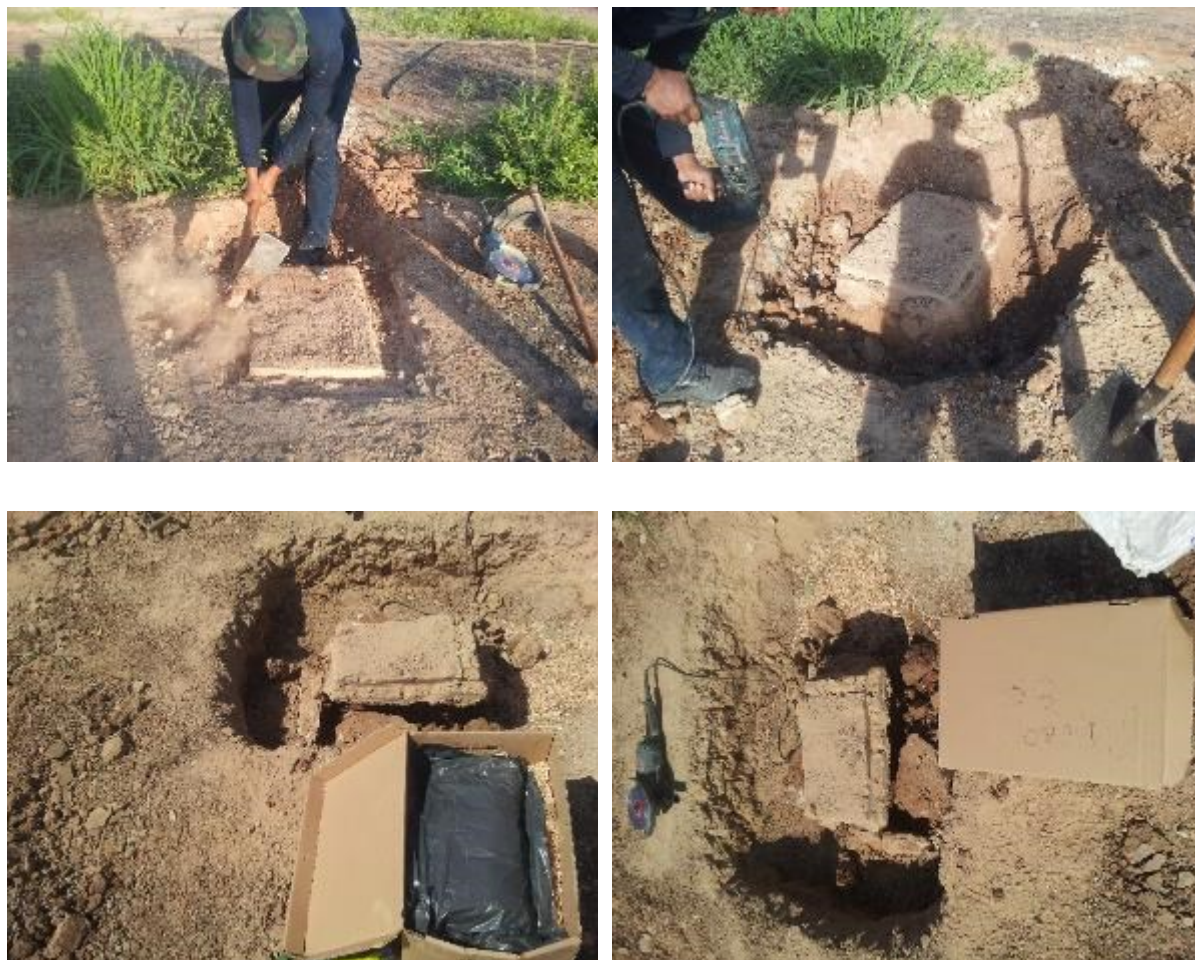
Figura 3.24 Extração dos blocos de solo cal 182 dias após compactação
