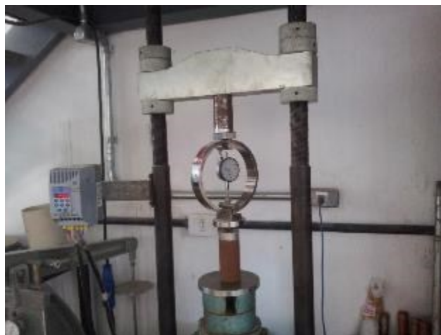
Figura 3.28 Ensaio de Resistência à Compressão Simples.
