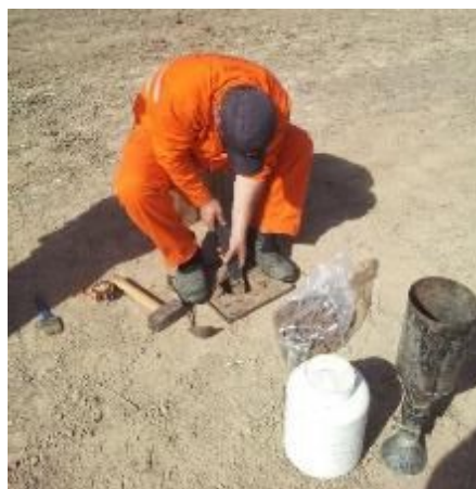
Figura 3.20 Controle da densidade in situ pelo método do cone de areia
