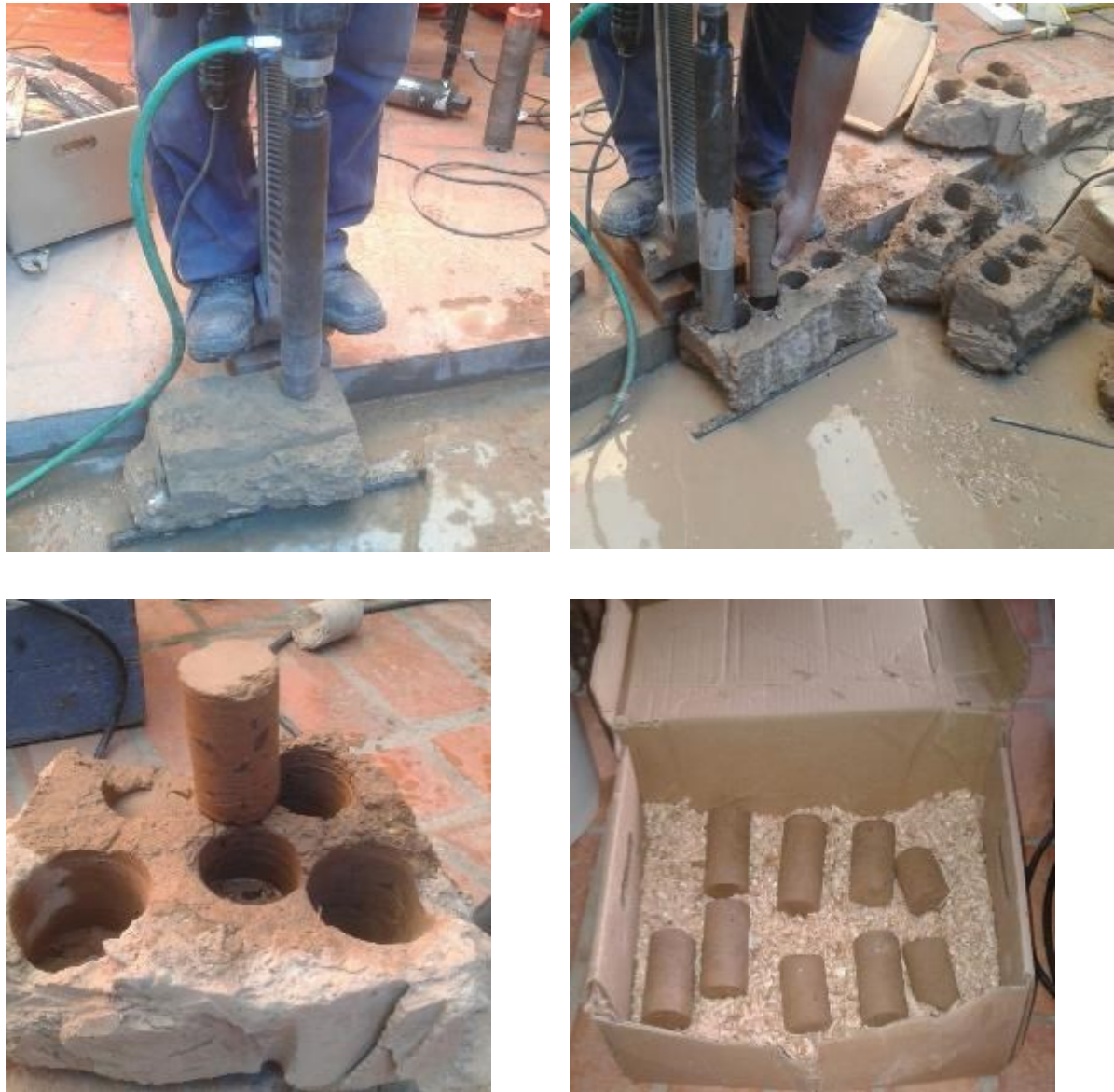
Figura 3.25 Extração de testemunhos para ensaios de resistência a compressão simples
