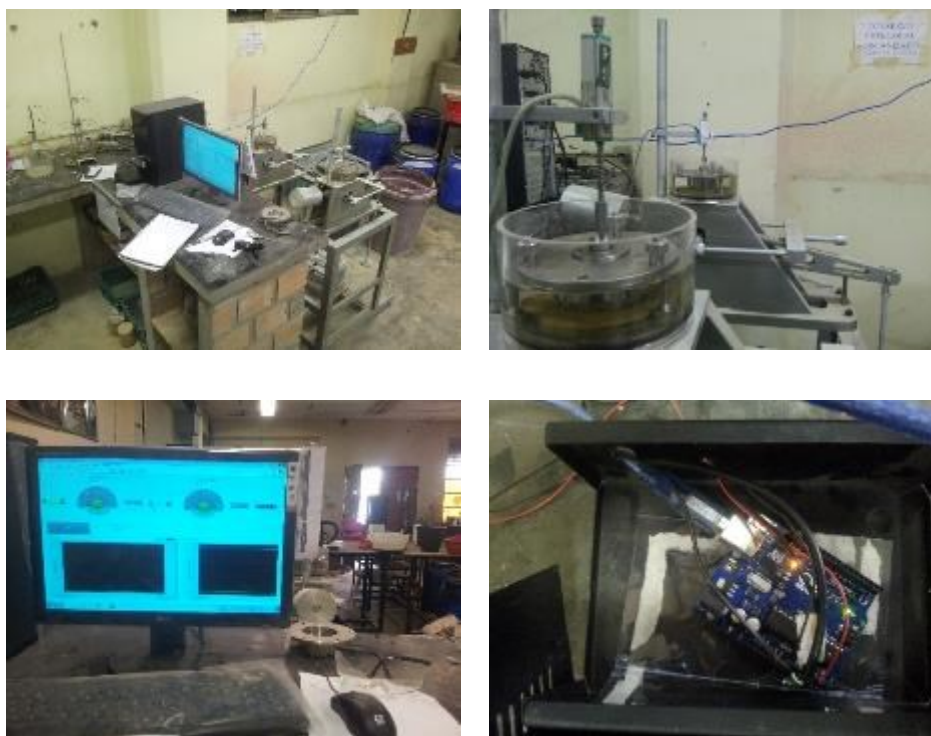
Figura 3.32 Instrumentação dos ensaios de expansão
