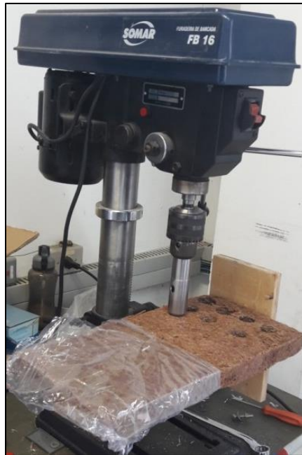
Figura 5.7. Demonstração de como as amostras foram extraídas a partir de uma furadeira de mesa
