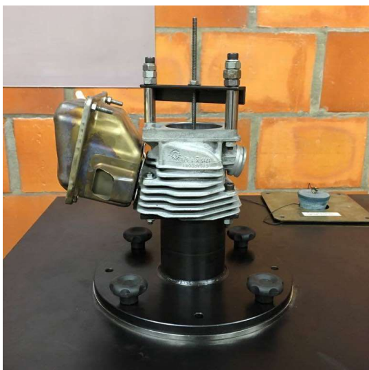
Figura 3.3.1: Aparato experimental para teste na bancada de fluxo, no caso de teste com o sistema de escape.
