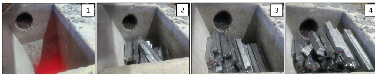
Figura 6.1: Sequência de carregamento do forno no experimento com apenas lingotes comuns. A cena 4 exemplifica o padrão de torre cheia mantido.
