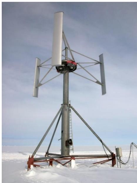
Figura 4.1 – Exemplo de turbina eólica H. Darrieus de três pás.
