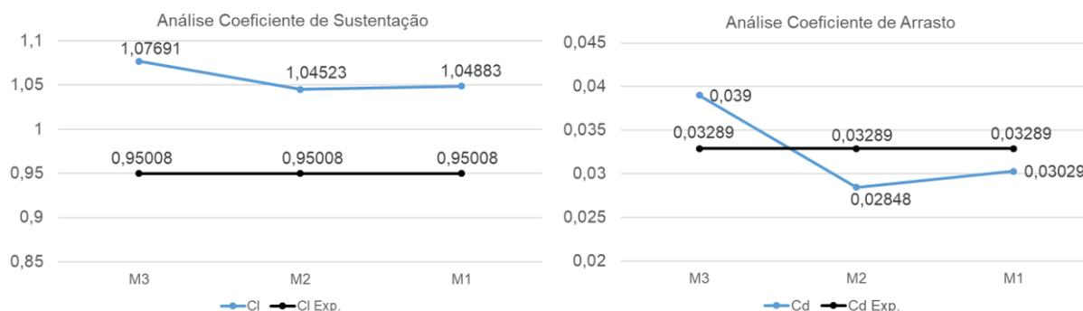
Figura 5.3 – Comparação dos resultados experimentais de Claessens, 2006 (em preto) com os resultados numéricos obtidos neste trabalho (em azul).
