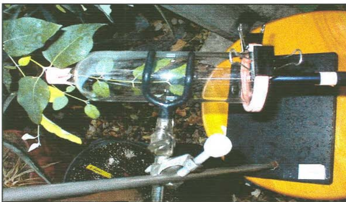
Figura 12. Amostragem dos voláteis emitidos por E. dunnii dentro da câmara de vidro silanizado.
