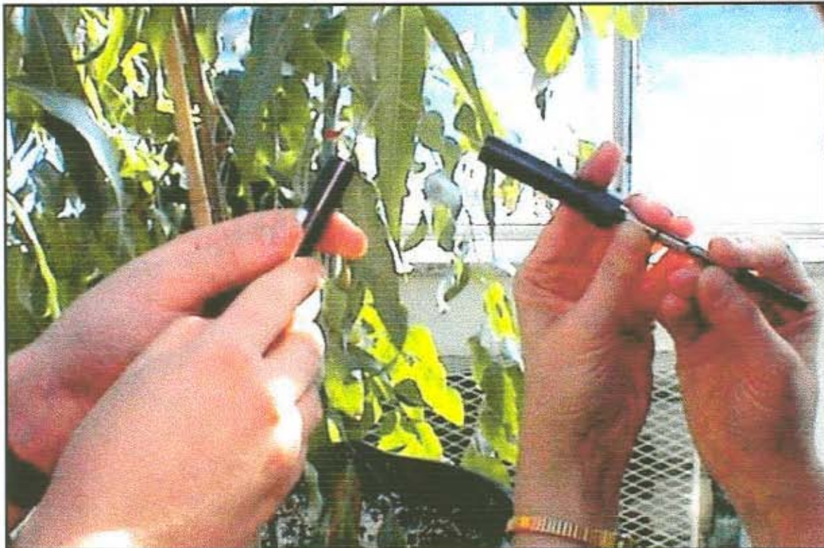
Figura 10. Técnica utilizada durante experimentos preliminares de amostragem de voláteis emitidos por folhas de eucalipto.
