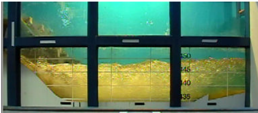
Figura 5.6 - Vista geral do escoamento ( Q_p=4.000 \text{ m}^3/\text{s} - S=1,61 ).
