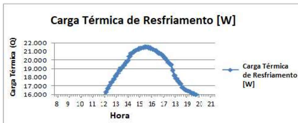
Figura 5.5 – Valores de carga de resfriamento para a edificação com uso do revestimento em um dia de análise com carga solar média para o verão. (Fonte: EnergyPlus 8.8 )
