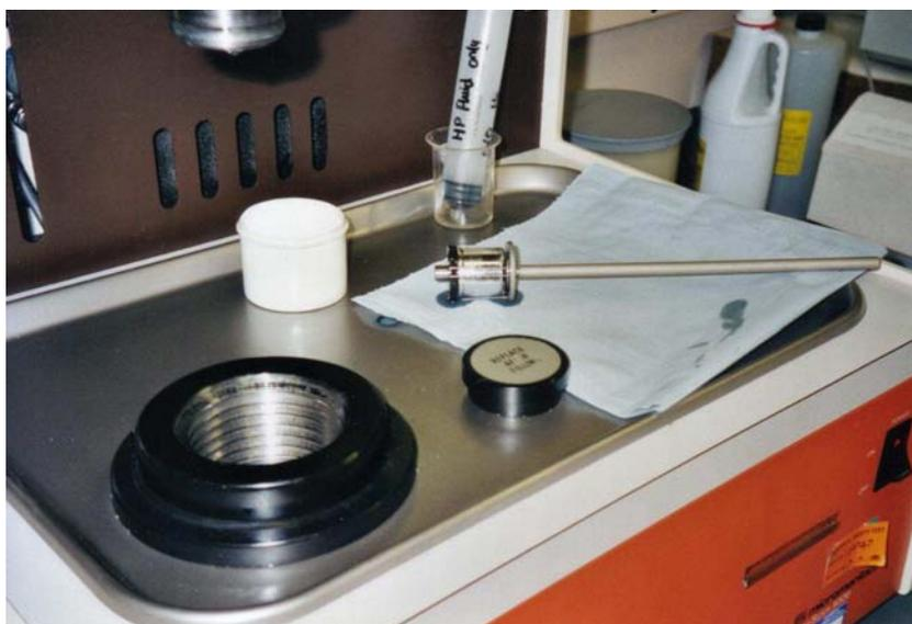
Figura 33: detalhe do penetrômetro antes da sua colocação na câmara de intrusão.
