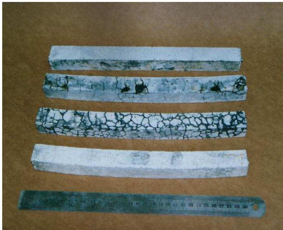
Figura 67: aspecto dos corpos-de-prova com riodacito R com diferentes teores de CCA-B ao final do ensaio acelerado.
