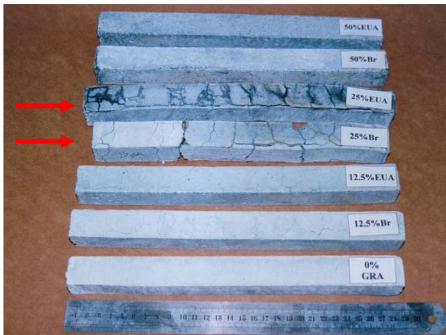
Figura 63: aspecto dos corpos-de-prova com granito GRA após o ensaio acelerado, destacando-se a acentuada flexão dos corpos-de-prova com 25% de CCA-B e CCA-E.
