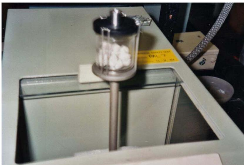
Figura 34: detalhe do penetrômetro com a amostra a ser ensaiada.
