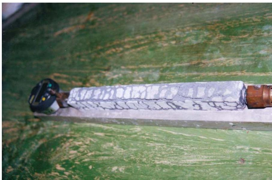
Figura 64: aspecto de uma barra com 25% de CCA-B e granito durante a medida de expansão.
