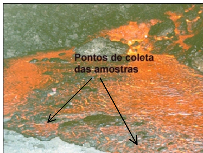
Figura 27 - Amostragem inicial do material. Coleta realizada nas bordas do leito de escória recém vazada.
