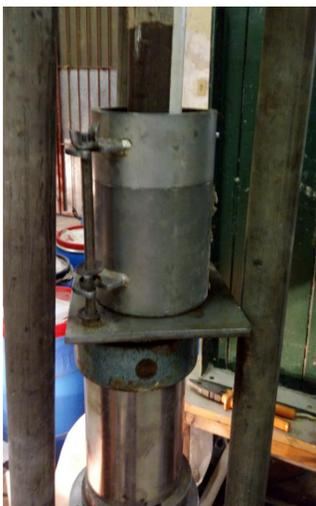
Compactação da mistura no molde de 100 mm de diâmetro e 127 mm de altura, utilizando-se macaco hidráulico.
