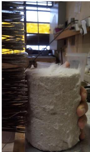
Processo de escovação dos corpos de provas, sobre balança, com o propósito de se assegurar a aplicação de 13 N em cada escovação.
