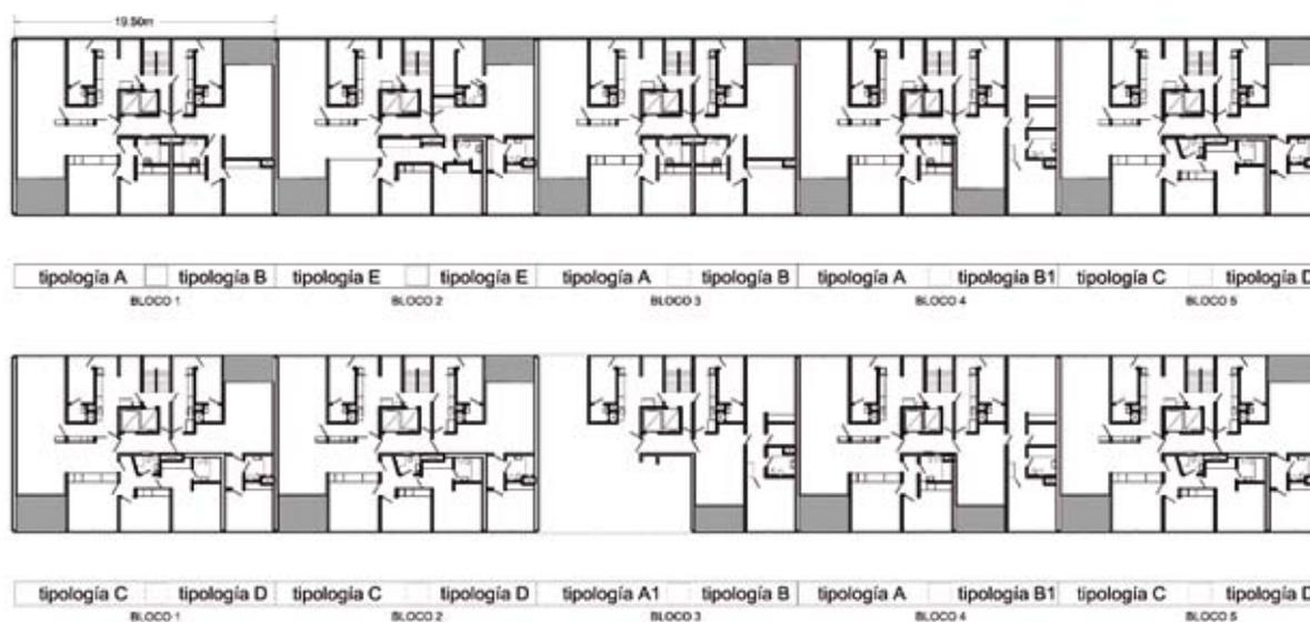
A flexibilidade estrutural permite que as tipologias possam ser implantadas em qualquer lugar dentro do andar, resultando uma mistura de apartamentos dentro do prédio.
