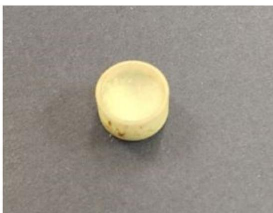
Figura 4.14: Imagem da amostra de cloreto de amônio após a secagem em estufa e compactação com ferramenta de aço.
