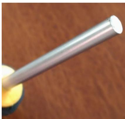
Figura 3.1: Instrumento utilizado para a compactação das amostras no cadinho de alumina.
