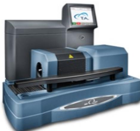
Figura 2.5: Termobalança utilizada nas análises termogravimétricas.
