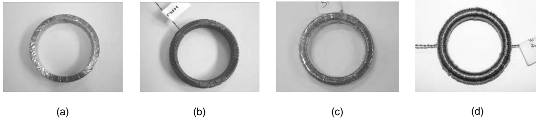
Figura 24 - Etapas de preparação das amostras: (a) isolamento, (b) enrolamento primário, (c) isolamento e (d) enrolamento secundário (20)
