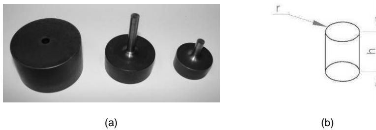
Figura 16 - (a) matriz para compactação e (b) geometria da amostra (20)
