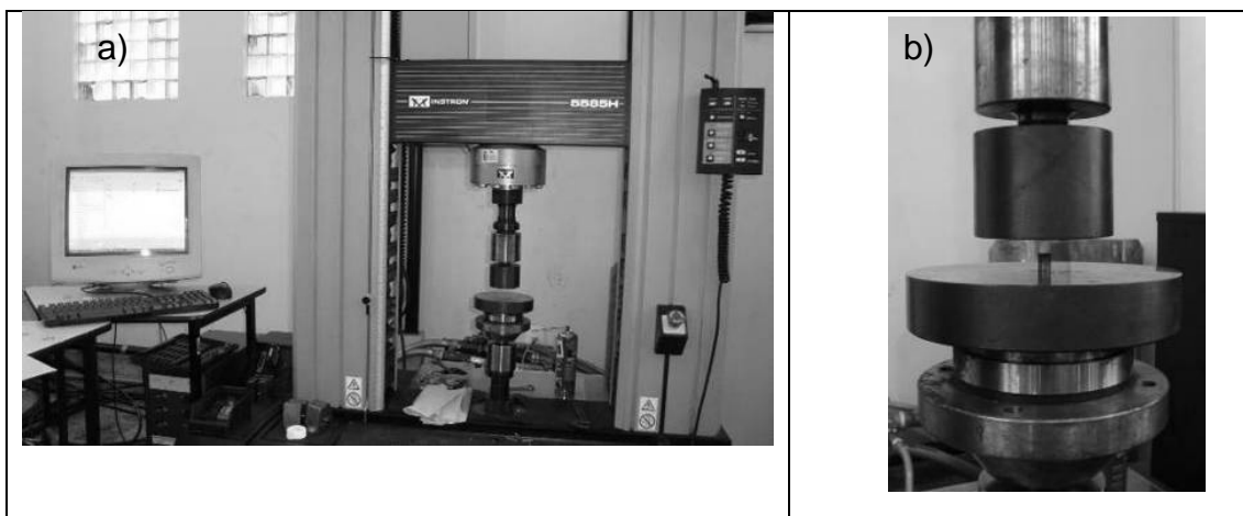
Figura 21: Máquina Universal de Ensaio Mecânico INSTRON. (a) Equipamento e captura de dados, (b) detalhe do dispositivo de ensaio.
