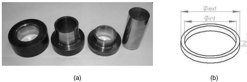
Figura 17 - (a) matriz para compactação e (b) geometria da amostra (20)
