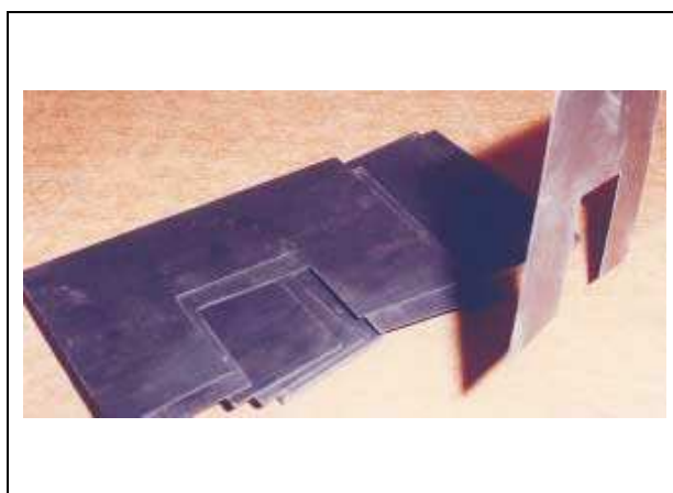
Figura 4 – Lâminas de silício empregadas como concentrador de fluxo (1)
