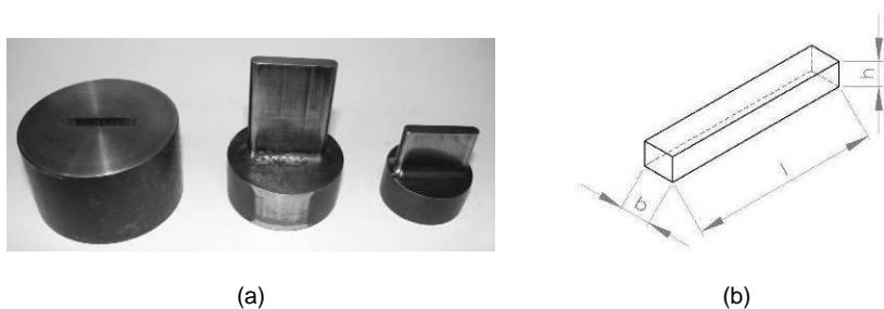
Figura 18: (a) matriz para compactação e (b) geometria da amostra (20)
