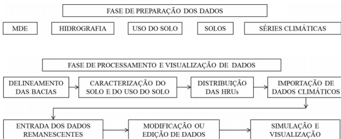
Figura 13 – Fluxograma de preparação e de processamento dos dados no modelo SWAT (Fonte: GALHARTE et al. , 2014)
