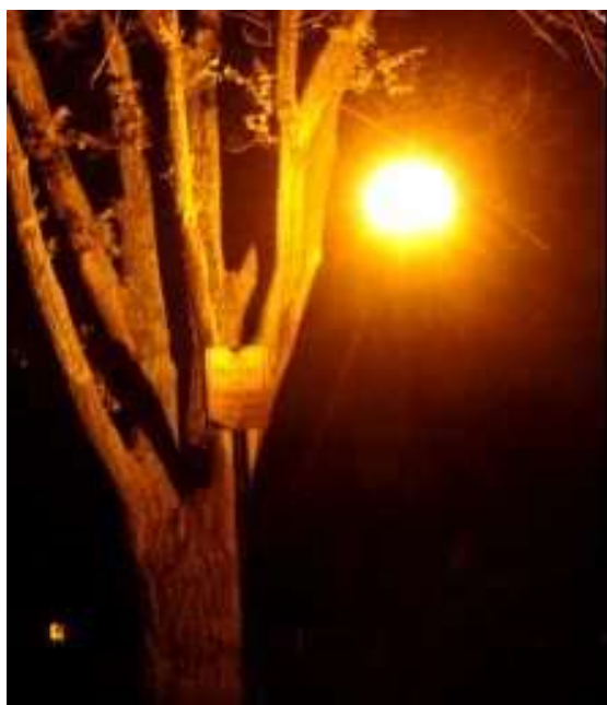
Figura 16 - Iluminação causando ofuscamento.
