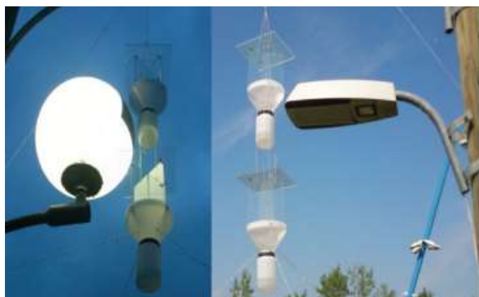
Figura 33 - Armadilhas para capturar insetos atraídos pelas luminárias.
