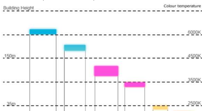
Figura 31 - - Iluminação da cobertura segue um padrão de temperatura de cor que varia conforme a altura.
