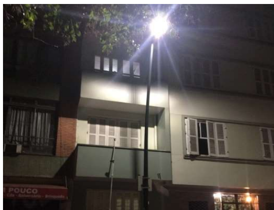
Figura 52 – Forma de medição da iluminação intrusiva, com luxímetro preso a suporte
