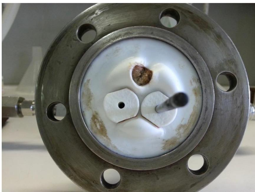
**Figura 28.** Tapa del reactor Chemipress después de la reacción de telomerización de 1,3-butadieno con ácido acético bajo las condiciones optimizadas.
