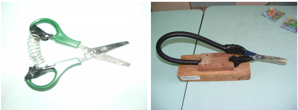
Figura 36: Modificações feitas em duas tesouras buscando facilitar a ação de recortar.
