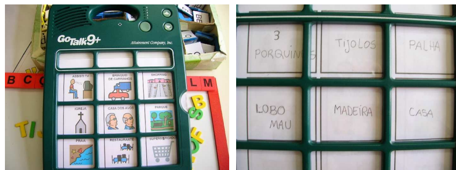
Figura 11: Vocalizadores com prancha de símbolos gráficos e com prancha de palavras.
