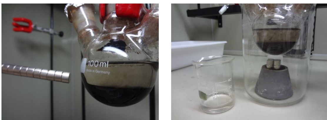
Figura 12. Separação da solução coloidal por força magnética.
