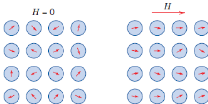
Figura 2 Momentos de dipolo magnético individuais de um material Paramagnéticos na ausência de um campo magnético externo \vec{H} (esquerda). Momentos de dipolo magnético individuais de um material Paramagnético, orientandos no mesmo sentido do campo magnético externo \vec{H} (direita). 24
