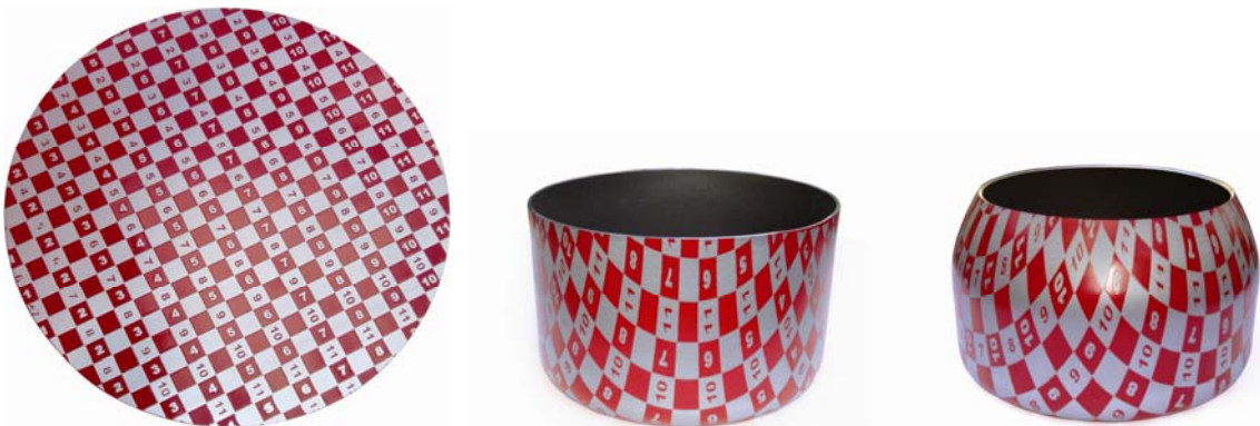
Figura 44 : Resultados físicos das etapas do processo de conformação da chaleira
