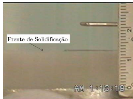
Figura 9. Detalhe da frente de solidificação no 2º termopar
