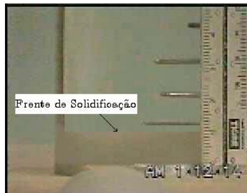
Figura 7. Frente de solidificação entre o 1º e o 2º termopar
