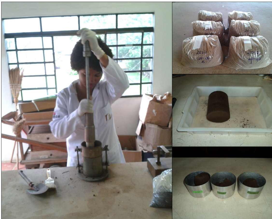
Figura 24. Ensaio de compactação em função da umidade do solo das áreas estudadas.
