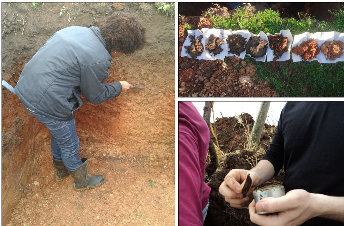
Figura 6. Avaliação do perfil do solo, em campo e coleta de amostras com estrutura deformada e indeformada para análise dos atributos físicos e químicos do solo.
