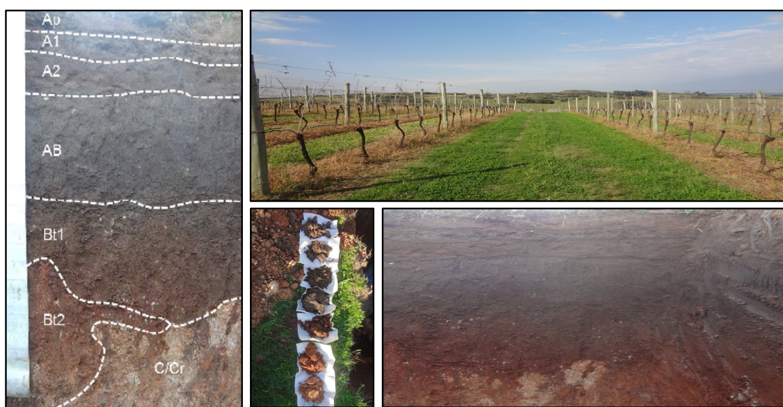
Figura 8. Argissolo Vermelho Distrófico típico PVd2 e sua posição na paisagem, com detalhe para o granito semi-intemperizado no horizonte mais profundo do solo (C/Cr).
