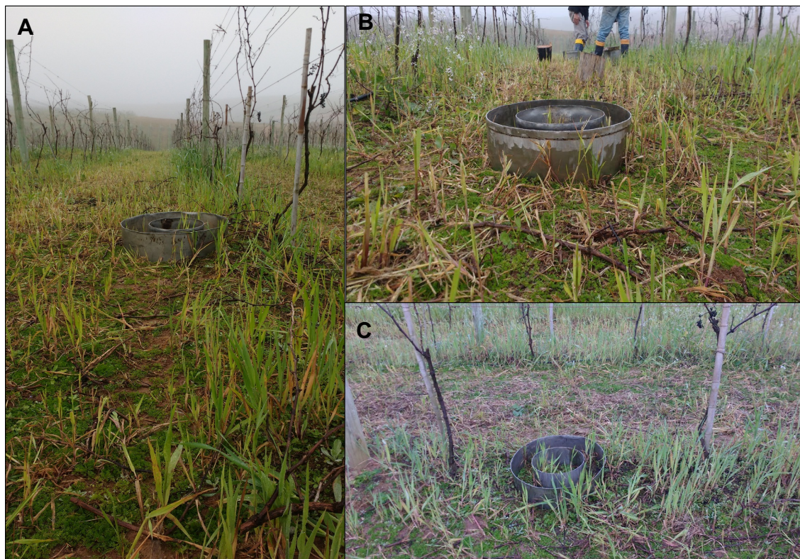
Figura 26. Determinação da infiltração de água no solo. A = local de tráfego do rodado do trator; B =entre rodados do trator; C = linha de plantio das videiras.
