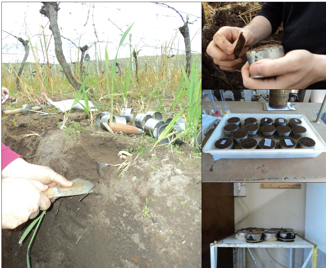
Figura 25. Amostragem de solo com estrutura preservada para análise da estrutura do solo.
