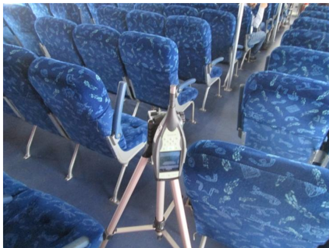
Figura 4.2: Conjunto decibelímetro e tripé no interior da embarcação.
