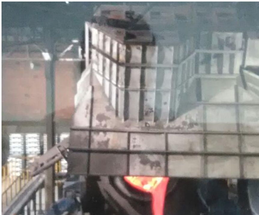
Figura 6 - Retirada da escória do forno rotativo.
