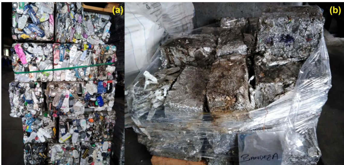
Figura 5 - Material a ser reciclado em alto forno; (a) embalagens de desodorante aerossol e (b) bandejas de alumínio prensadas.
