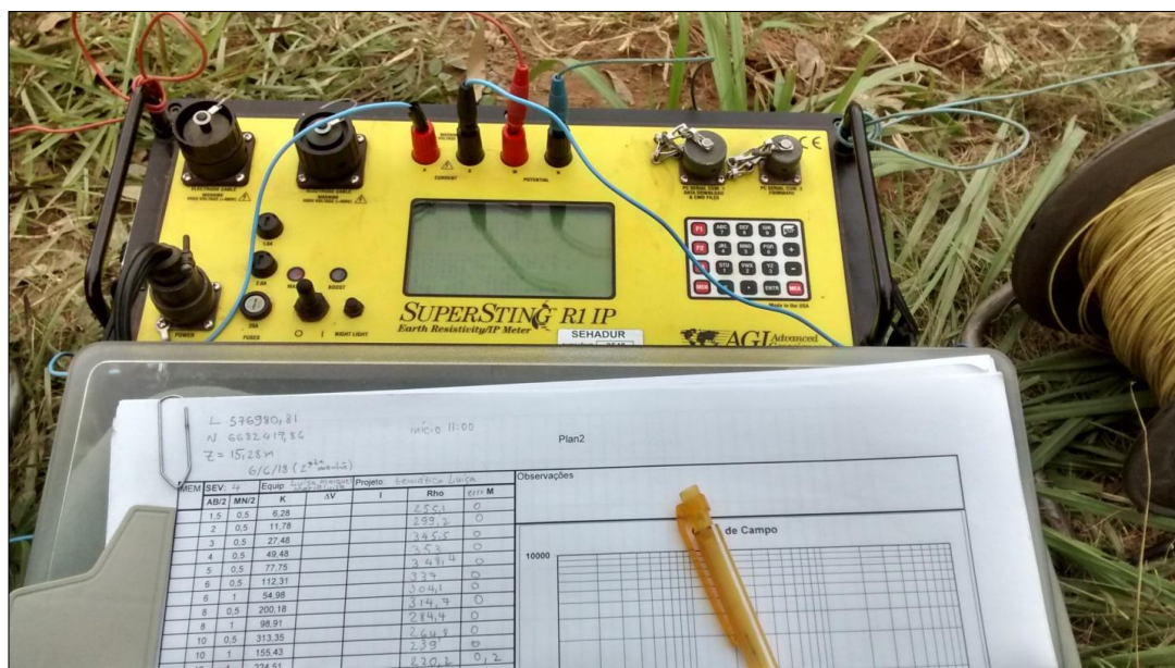
Foto 17. Visão do(a) operador(a) do equipamento eletrorresistívmetro, com detalhe para a planilha de campo, com os arranjos dos eletrodos e respectivos valores de resistividade aparente. (Elaborado pela autora).
