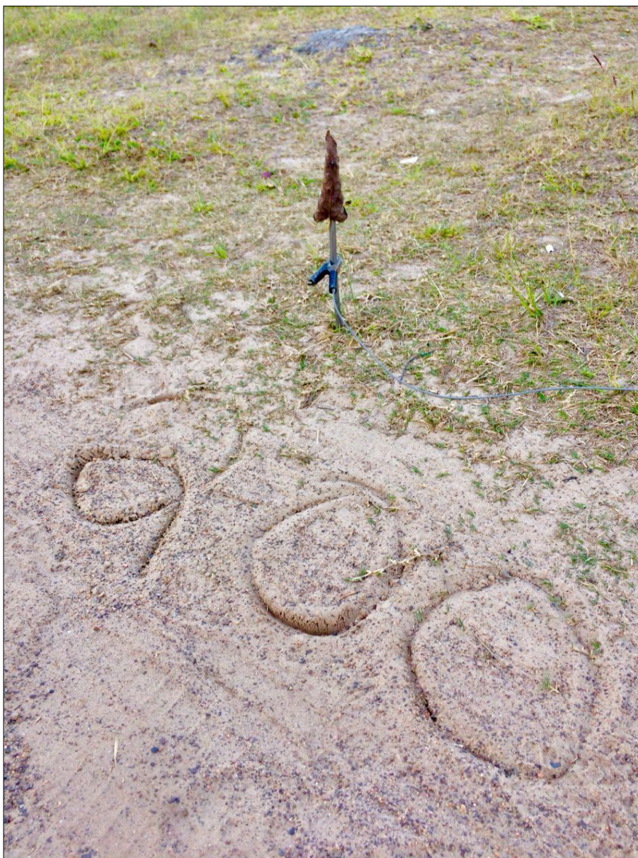
Figura 16. Identificação da distância do pino em relação ao ponto central, neste caso de 200 metros, feita diretamente no solo. O clipe “jacaré” está preso no pino e uma folha foi colocada no pino para facilitar a visualização do mesmo. (Elaborado pela autora).
