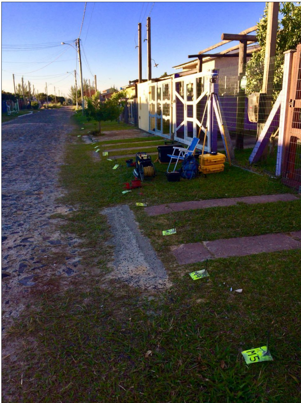
Fig 19. Levantamento em estrada de paralelepípedo e acostamento. As etiquetas em amarelo facilitam na identificação das distâncias dos eletrodos a partir do ponto central. (Elaborado pela autora).
