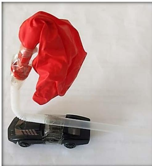
*Figura 4 Carrinho com canudo e balão acoplados para demonstração do Princípio da ação e reação (3ª Lei de Newton).*
