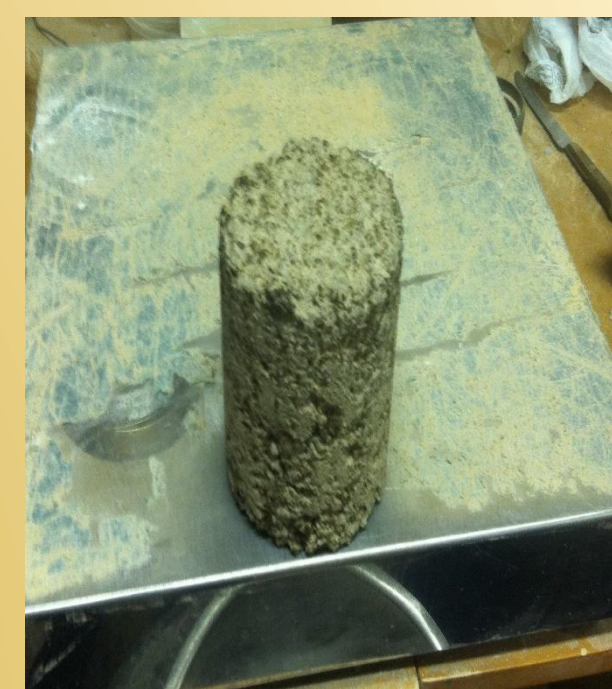
Figuras 5 (acima) e 6 (abaixo) - Corpos de prova em saturação. Corpo de prova após escovação.
