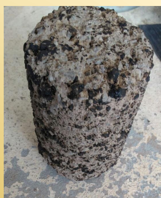
Figuras 3 (acima) e 4 (abaixo) - Corpo de prova após escovação. Degelo à \pm 23^\circ\text{C} .
