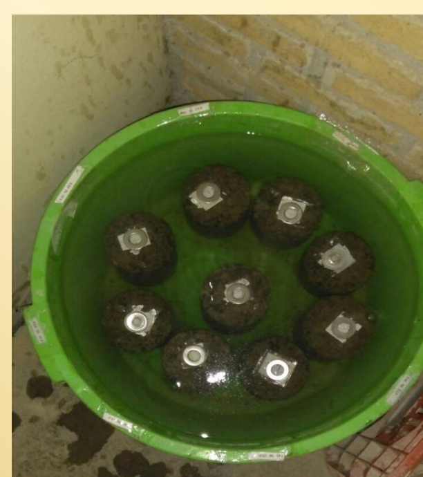
Figuras 5 (acima) e 6 (abaixo) - Corpos de prova em saturação. Corpo de prova após escovação.
