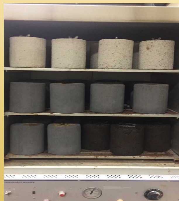
Figuras 1 (acima) e 2 (abaixo) - Secagem à \pm 70^\circ\text{C} . Congelamento à \pm 23^\circ\text{C} .
