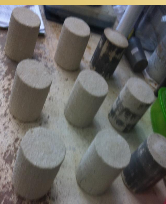
Figuras 3 (acima) e 4 (abaixo) - Corpo de prova após escovação. Degelo à \pm 23^\circ\text{C} .
