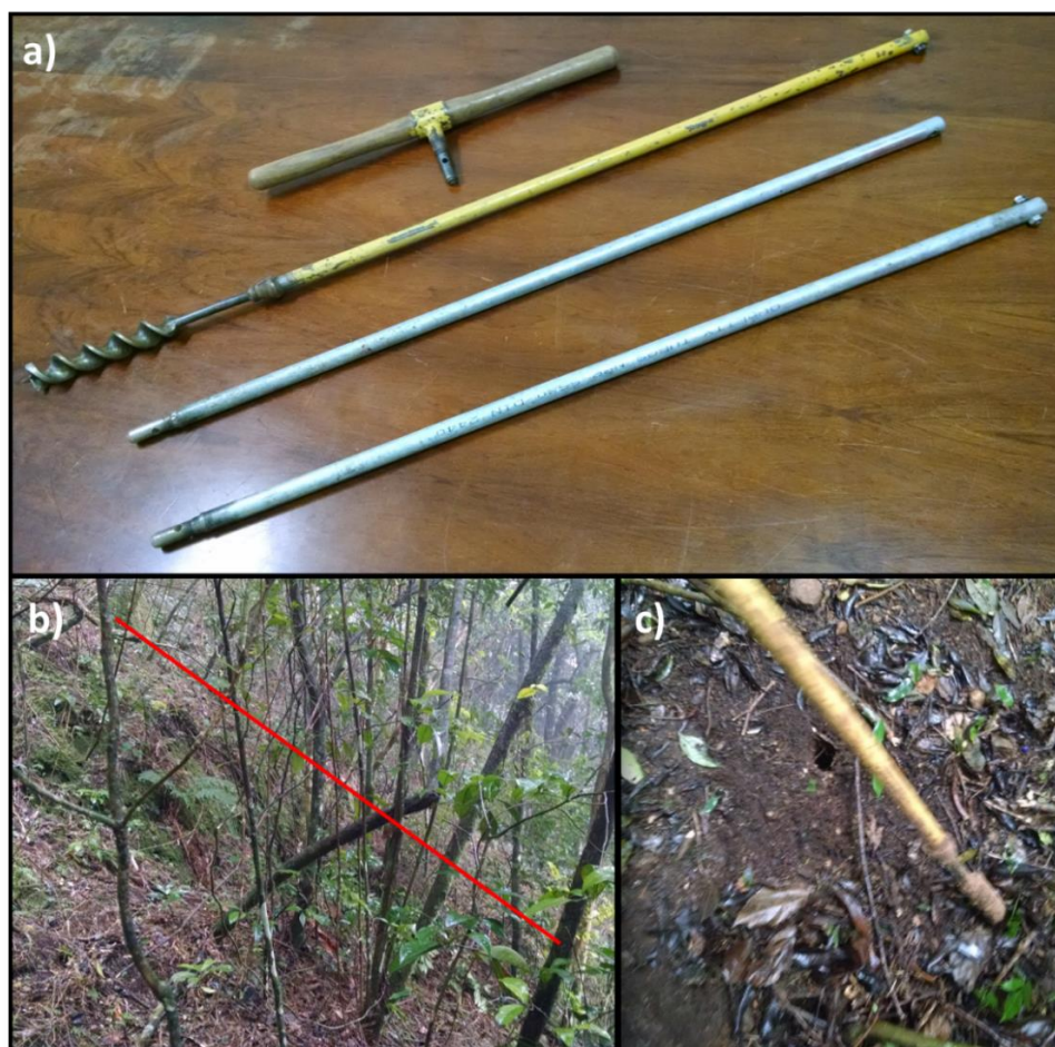
Figura 22 – Tradagem na bacia de estudo. a) Trado espiral e extensores utilizados no presente trabalho; b) Encosta tipicamente selecionada para amostragem, com declividade próxima de 45°; c) Furo de sondagem.
