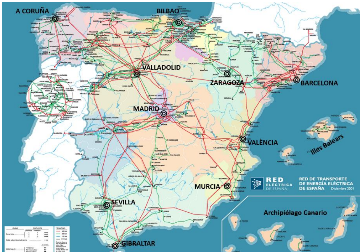
Figura 8 - Rede de transmissão de alta e extra alta tensão do sistema espanhol
