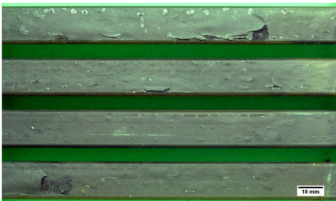
Figura 41- Fotografia do estado superficial dos fios após o período de pré-corrosão.
