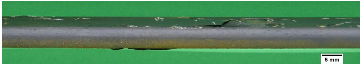
Figura 42- Imagem lateral do fio onde se observa o descolamento da camada de produto de corrosão.
