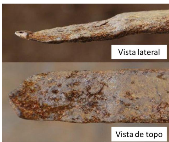
Figura 9- Fio de armadura de tração corroído após a ruptura da capa externa de um duto flexível.
