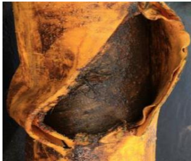
Figura 6- Típico dano de capa externa causado por aumento de pressão no ambiente anular.
