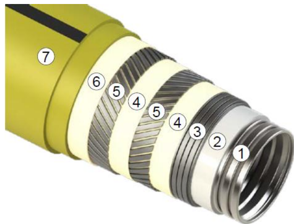
Figura 3- Configuração tradicional de um duto flexível.
