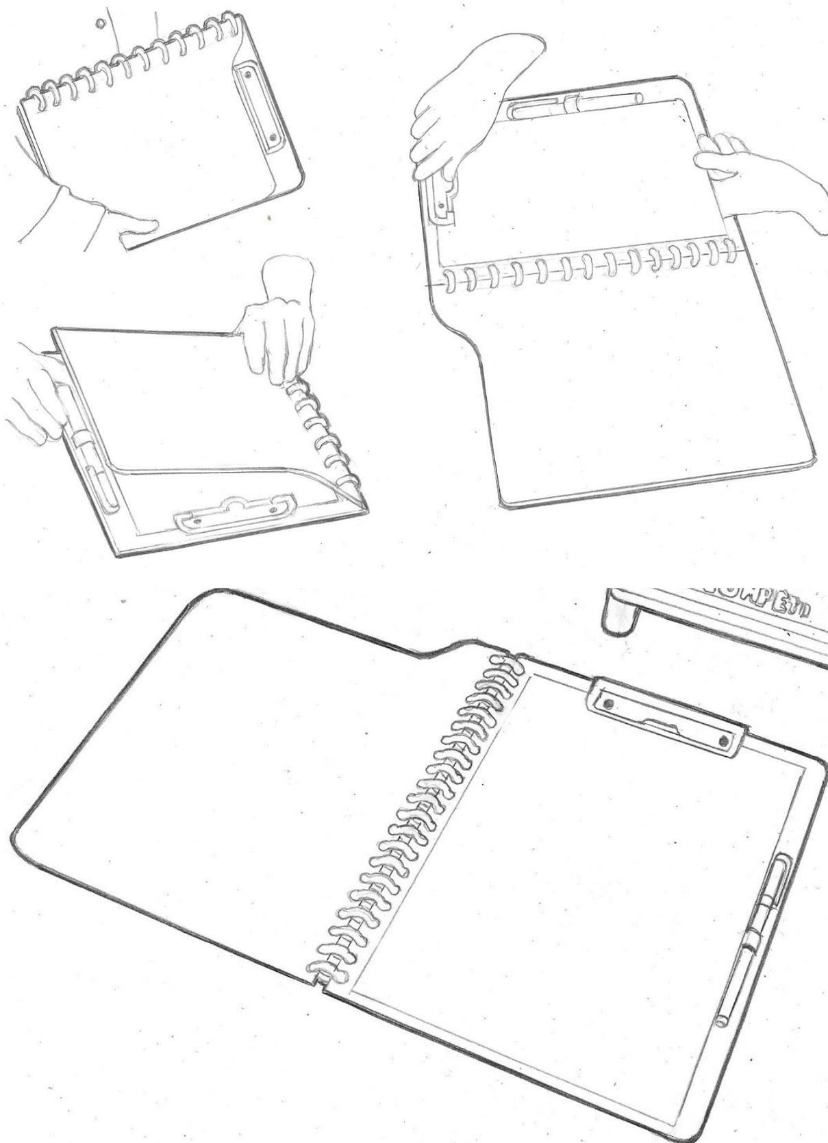
A alternativa 3B, figura 13, apresenta o clipe na horizontal na parte de cima da prancheta, um recorte na capa, espiral para a união e elástico para o fechamento e suporte de caneta ou lápis.
