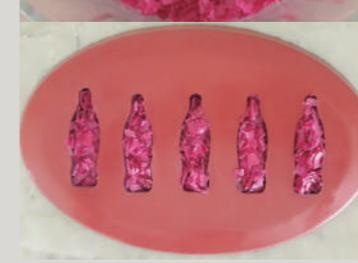
Lubrifique os moldes, preencha-os com os pedaços de PET e leve ao forno elétrico convencional por 30 minutos, a 260 °C. Retire do forno e comprima a abertura dos moldes com uma chapa e sargentos.
