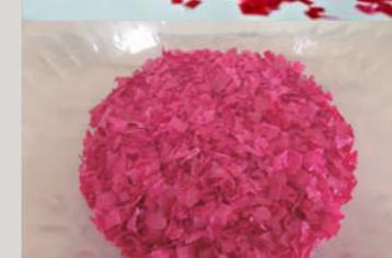
Reúna os pedaços cortados e os coloque em um moinho de facas ou processador de alimentos para reduzi-los em até 3 mm.
