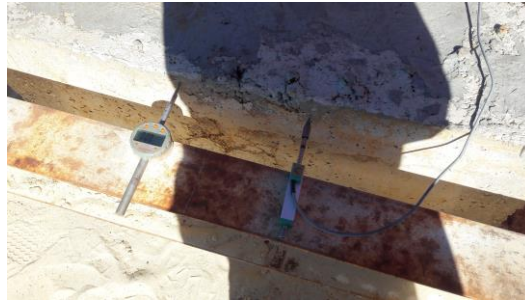
Figura 3.20: relógio comparador e transdutor de deslocamento.
