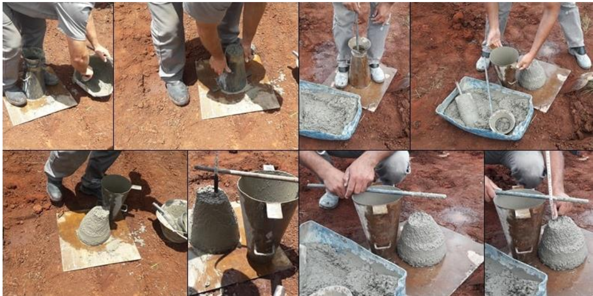
Figura 3.11: Procedimentos do ensaio de abatimento (caminhão 1 e caminhão 2).
