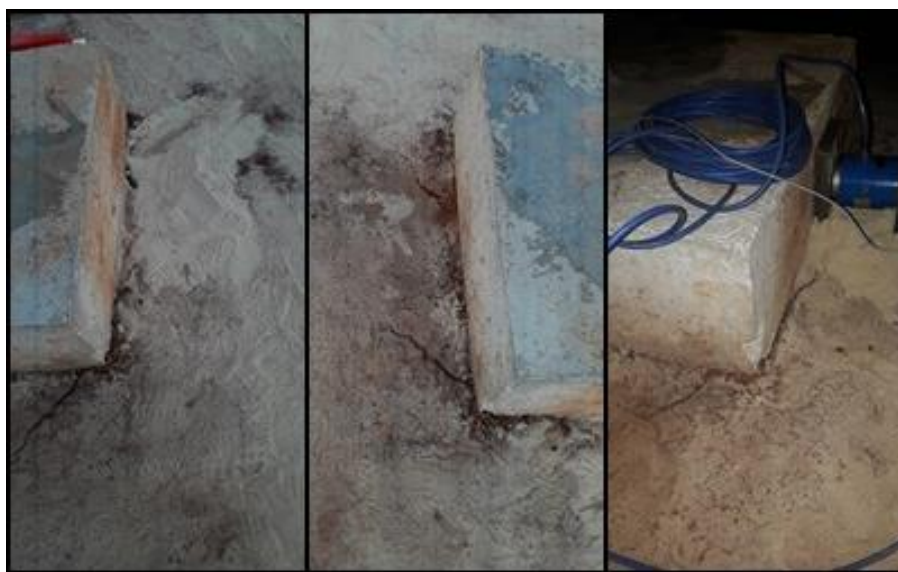
Figura 4.66: Mecanismo de ruptura das estacas carregadas lateralmente.
