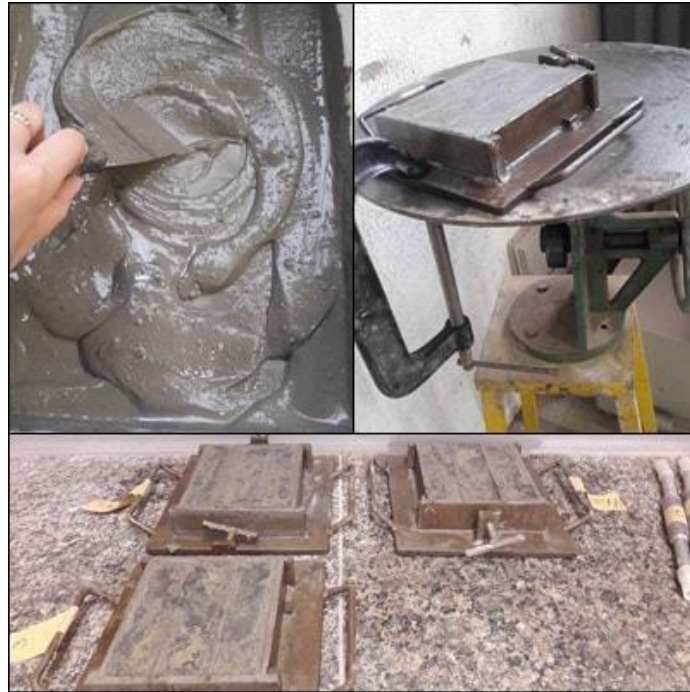
Figura 3.16: Procedimentos para amostragem dos corpos de prova de calda de cimento.
