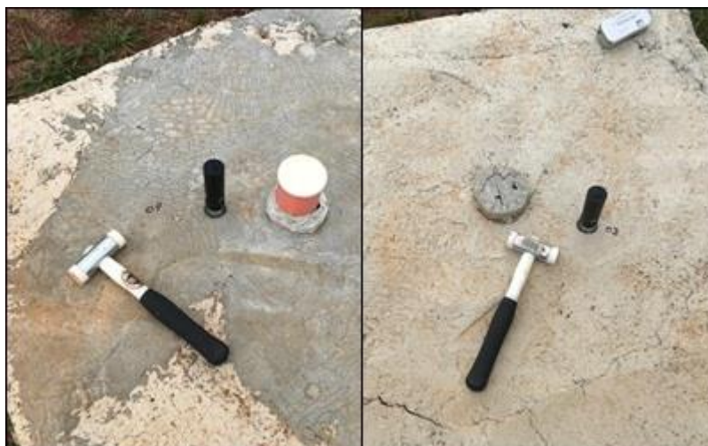
Figura 4.67: Posicionamento dos equipamentos para o ensaio de integridade.
