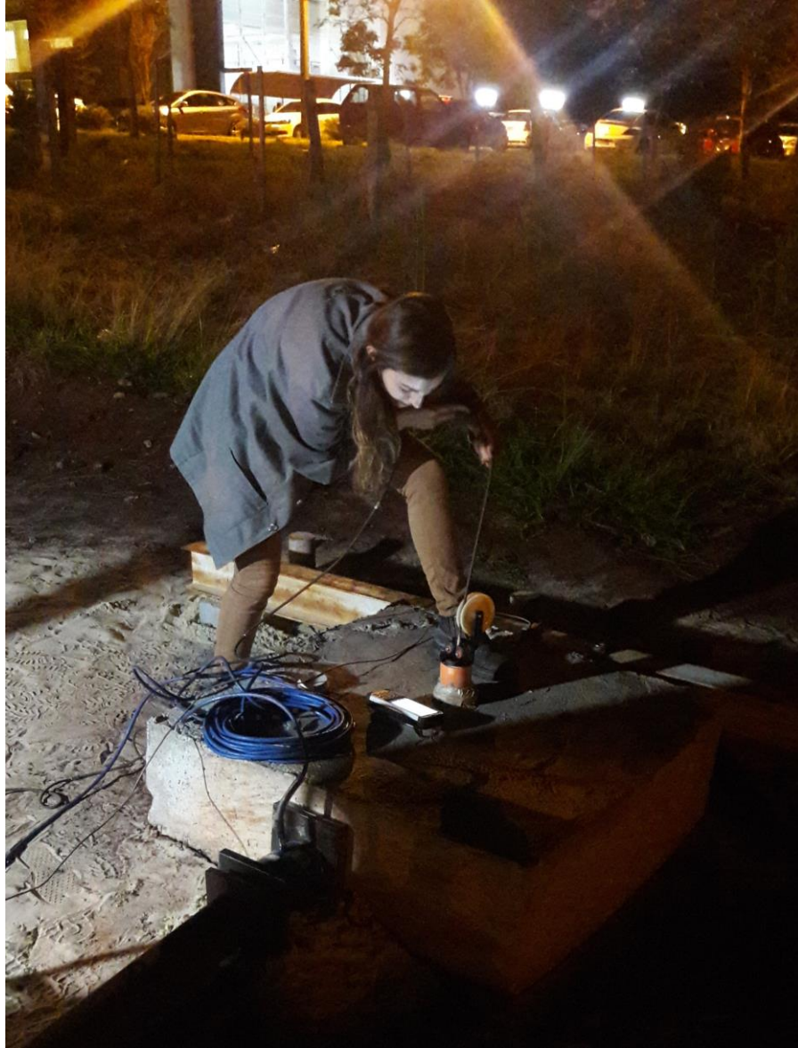
Figura 3.24: Utilização do inclinômetro em campo experimental.
