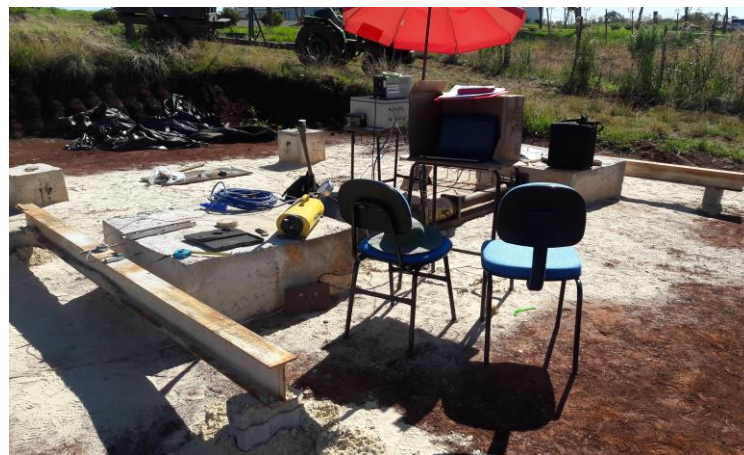
Figura 3.21: Visão geral do sistema montado para leitura dos deslocamentos.
