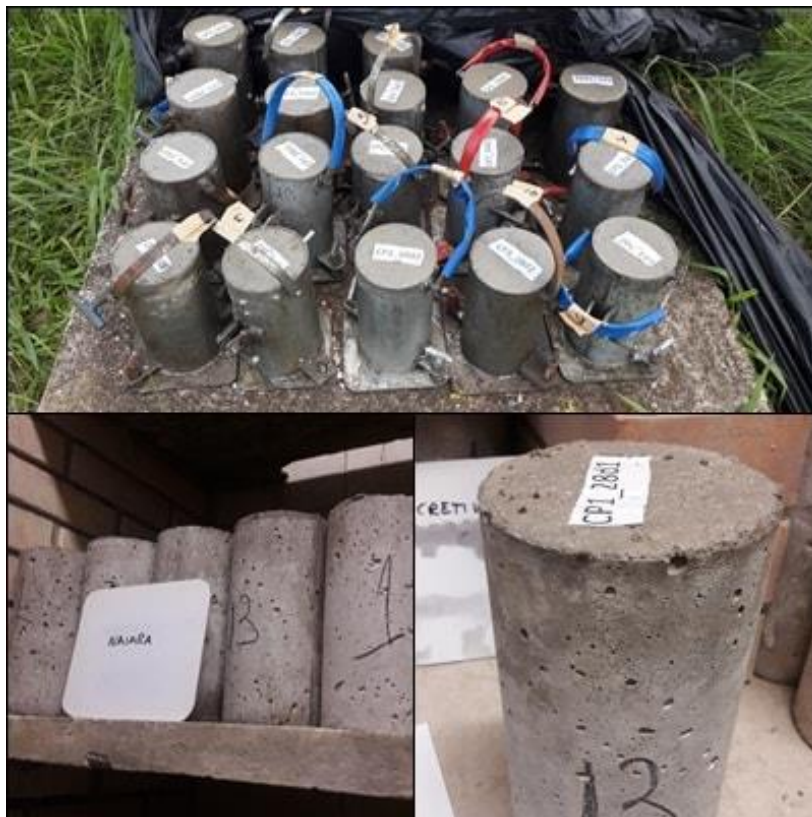
Figura 3.12: Corpos de prova de concreto na forma e na câmara úmida após serem desmoldados.
