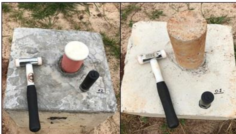
Figura 4.57: Posicionamento dos equipamentos para o ensaio de integridade.
