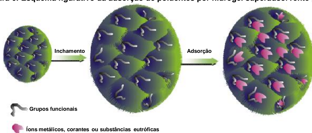
Figura 6: Esquema figurativo da adsorção de poluentes por hidrogel superadsorvente [180].
