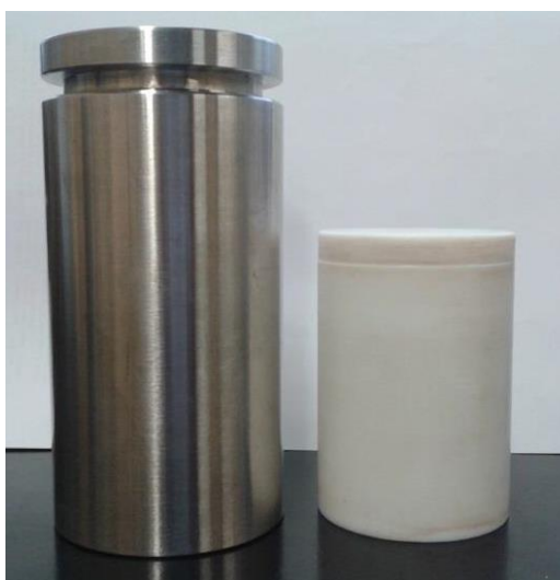
Figura 8 - Reator de aço-inoxidável, com cápsula de teflon interna, utilizado na síntese zeolítica.
