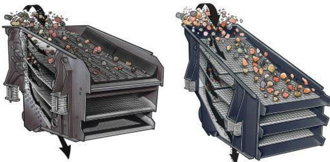
Figura 20: Peneiras moduladas de três decks.
