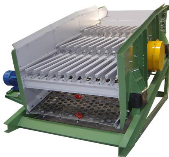
Figura 8: Grelha vibratória com crivo de finos.
