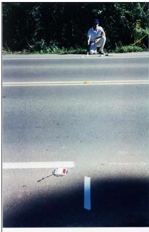
FIGURA 3.4 - Ajuste para Determinação da Seção Perpendicular ao Alinhamento
