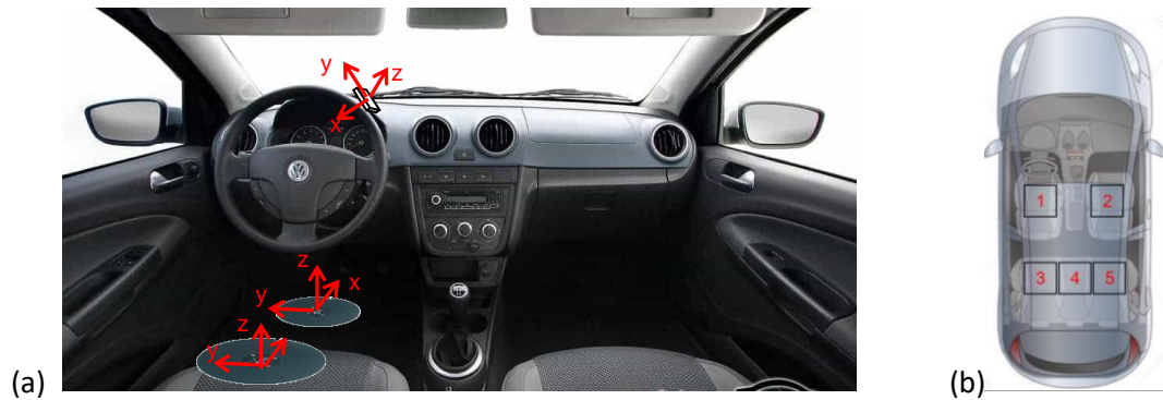
Figura 4.2 – Locais de medição da aceleração (a) no interior do veículo para posição 1 e (b) demais posições medidas. (FONTE: Autor)
