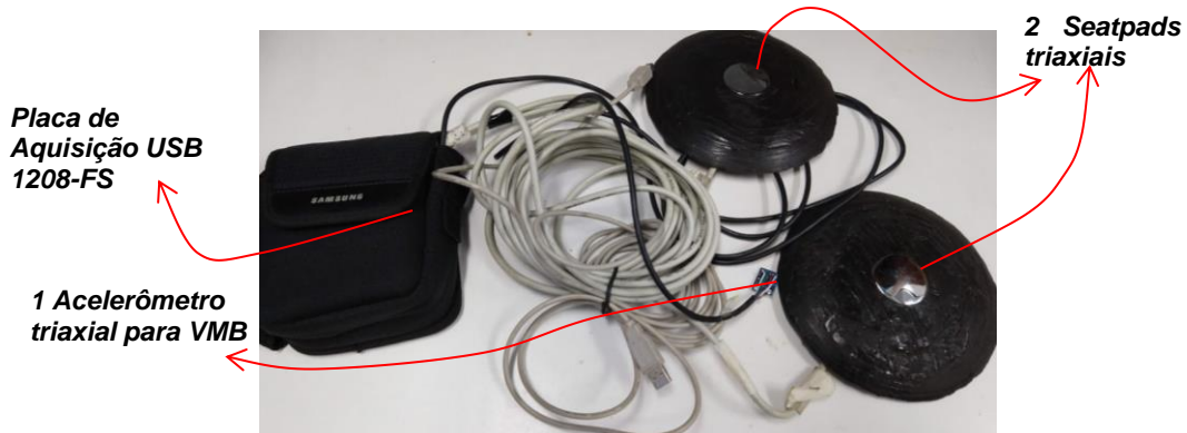
Figura 4.1 – Sistema dois seatpad tri-axiais e acelerômetro extra para medição no volante. (FONTE: Autor)
