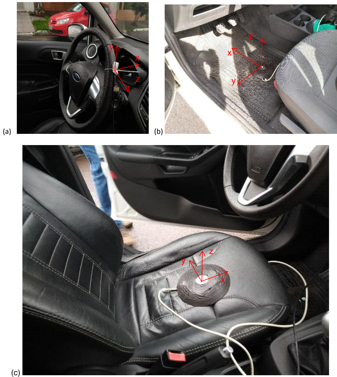
Figura A.7 – Seatpad e acelerômetros posicionados corretamente no piso e no assento, da esquerda para a direita, para procedimento de medição de vibração. Eixos coordenados indicam orientação final dos acelerômetros.
