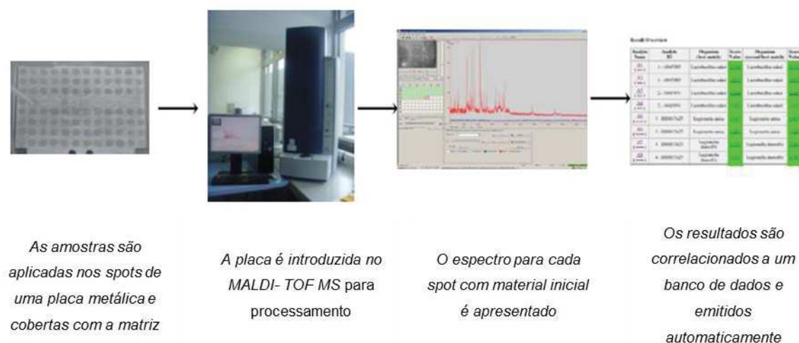
Figura 2: Esquemática das análises via MALDI-TOF MS. Fonte: Pavlovic et al (2013), adaptado
